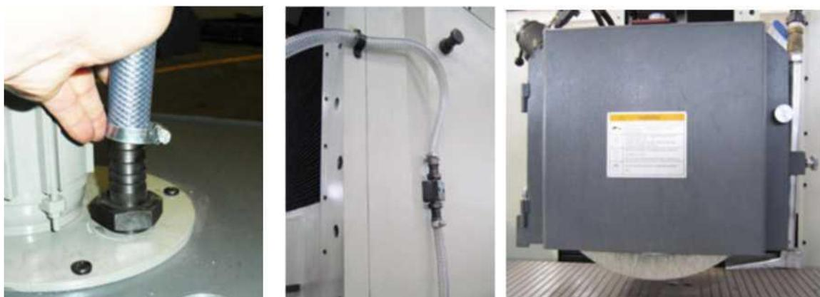
Очищайте бак и заменяйте охлаждающую жидкость по мере необходимости (охлаждающую жидкость следует заменять не реже одного раза в три месяца)
