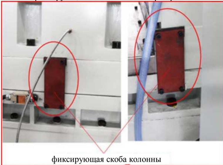
фиксирующая скоба колонны
