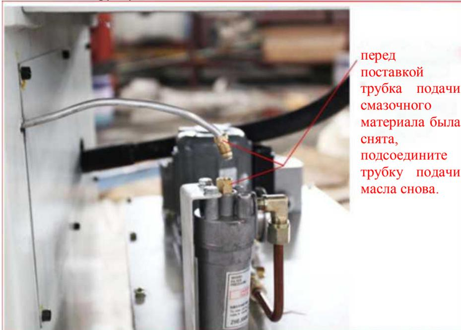
перед поставкой трубка подачи смазочного материала была снята, подсоедините трубку подачи масла снова.
