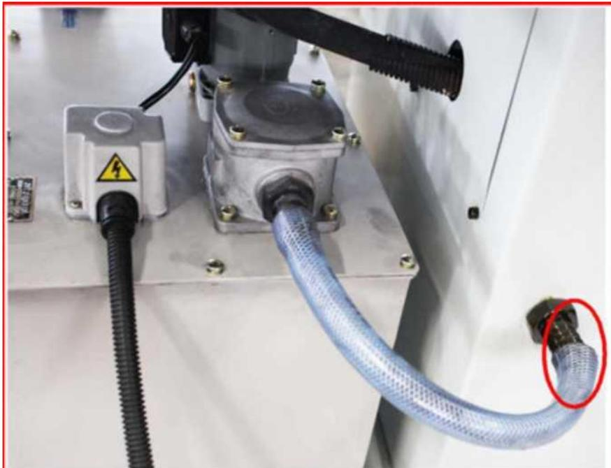
перед поставкой трубка возврата смазочного материала была снята. Подсоедините ее снова.
