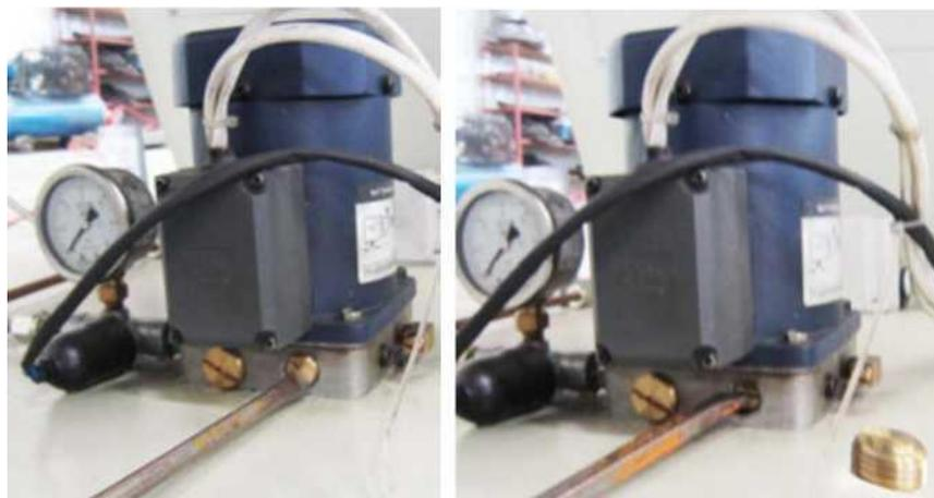
Перед запуском станка сначала запустите гидравлическую станцию. Через 20 минут смазочное масло покроет все направляющие, после чего можно запускать станок.
